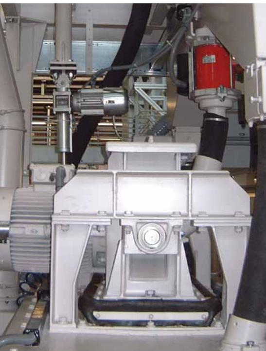
*Une turbine à haute performance d'**AGTOS** inclinée sur une grenailleuse à satellite à table rotative.*
