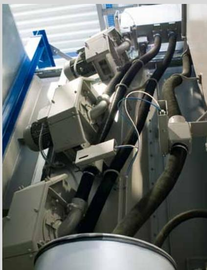
Des turbines à haute performance d'AGTOS sur une grenailleuse à charge suspendue continue.
