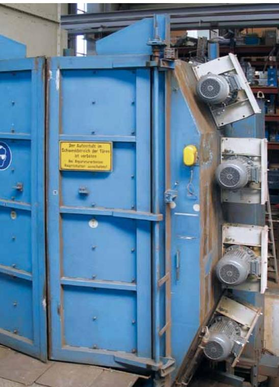
Les turbines à haute performance d'**AGTOS** sont souvent installées sur de vieilles machines. Par exemple ci-dessus sur une machine à charge suspendue.
