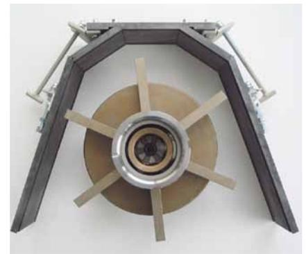
Pour l'exécution en acier à outils et pour des raisons de techniques de fabrication, l'optimisation d'écoulement est gagnée par la mise en place de pièces d'angle supplémentaire.
