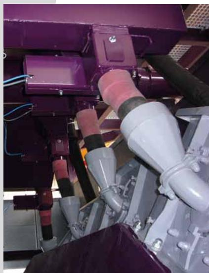
Des turbines à haute performance d'AGTOS sur une grenailleuse à convoyeur à rouleaux.
