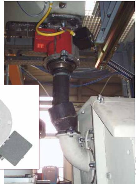
Pour certaines applications de grenailage, par exemple le shot peening, il est avantageux d'équiper les turbines avec des variateurs de fréquence permettant un réglage continu de la vitesse de rotation des moteurs de turbine.
