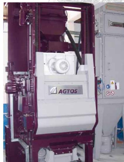
De turbine à haute performance d'AGTOS sur une grenailleuse à tablier retourneur.
