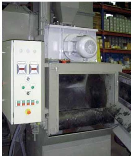
La turbine à haute performance d'**AGTOS** sur une machine à convoyeur à rouleaux (en haut) et sur une machine à tablier retourneur (en bas).
