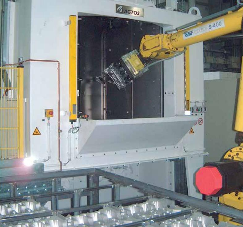
Les **grenailluses à table rotative** sont construites sous différentes tailles et versions. Pour la fixation, l'industrie automobile utilise également des grenailluses satellites à table rotative. Une haute cadence et les résultats fiables du grenaillage en sont la preuve. De plus, elles permettent l'automatisation du processus.
