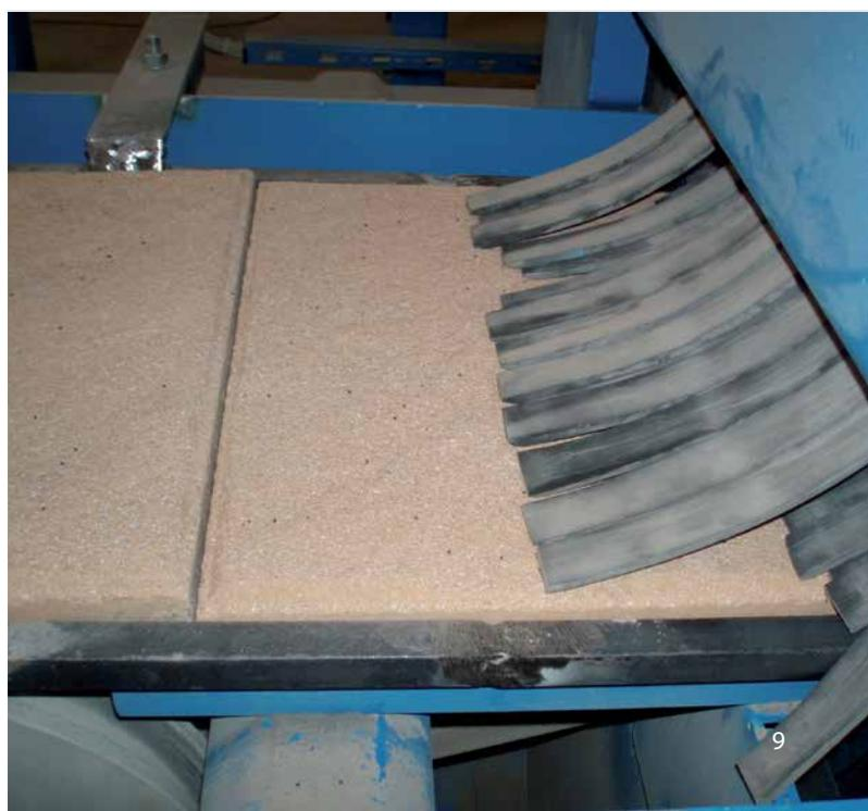
Les **grenailleuses à tapis métallique** sont utilisées pour l'usinage des pièces les plus diverses. Votre avantage est de pouvoir grenailer la pièce des deux côtés simultanément.
