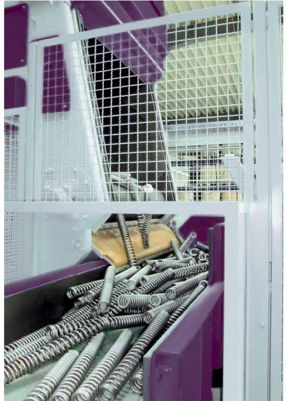
*Grenailleuse à tablier retourneur métallique pour durcir des ressorts hélicoïdaux*
