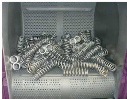
Grenailleuse à convoyeur à tablier retourneur en caoutchouc pour durcir des ressorts hélicoïdaux
