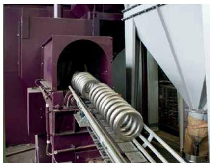
*Entrée et sortie d'une grenailleuse à transport par cylindres pour nettoyer des ressorts hélicoïdaux*
