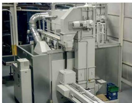
*Grenailleuse à transport par cylindres pour durcir des ressorts en spirale longs*
