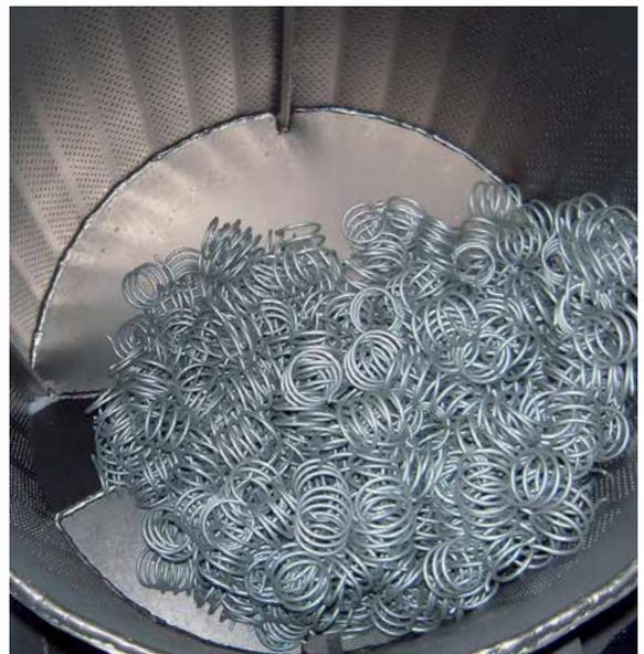
*Grenailleuse à tambour pour durcir des ressorts hélicoïdaux*
