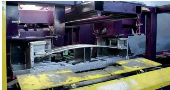
*Dispositif de précontrainte pour ressorts à lames avant le traitement dans une grenailleuse à convoyeur à rouleaux*
