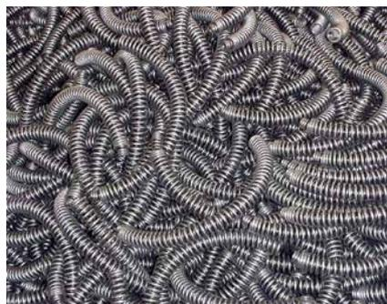
Ressorts en arc après grenailage dans une grenailleuse à convoyeur à tablier retourneur en caoutchouc
