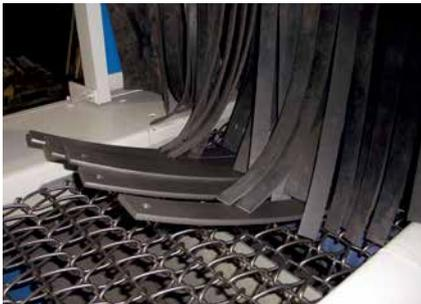
*Sortie d'une grenailleuse à tapis métallique pour durcir de ressorts à lames*
