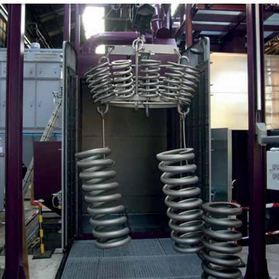
Grenailleuse à charge suspendue pour le traitement des ressorts hélicoïdaux. La cabine de grenailage mesure 1 700 x 1 700 mm.
