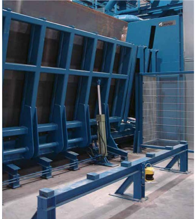
*Grenailleuse à convoyeur à rouleaux vertical*
