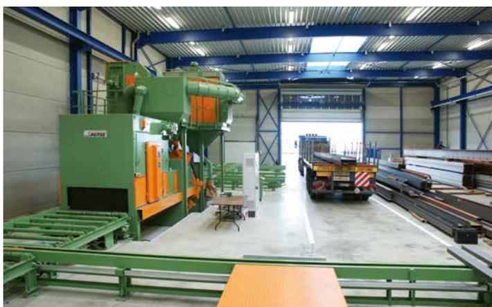
*Des transbordeurs transversaux relient la grenailleuse aux machines de sciage et perçage*
