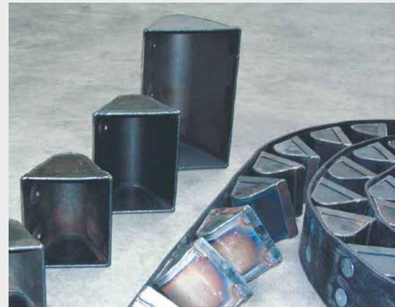
Bandes, godets pour élévateur à godets et vis pour les grenailleuses de tous les fabricants
