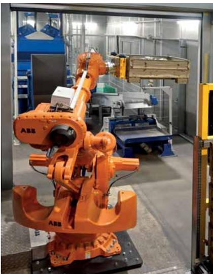
*Le robot est l'élément central de la cellule de grenailage.*
