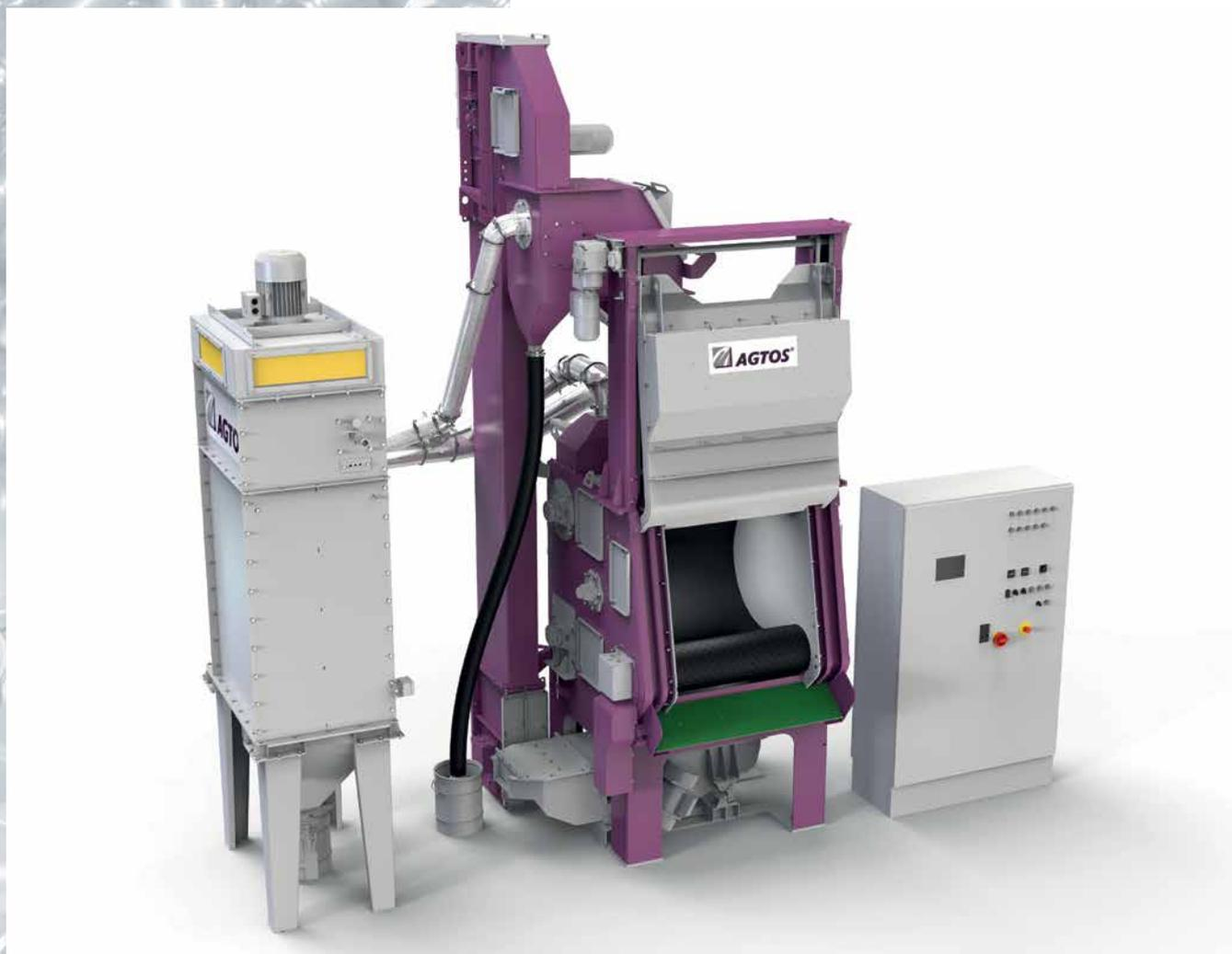
Le principe de grenailage dans un tablier retourneur s'est imposé comme le procédé le plus efficace pour le décalaminage, ébarbage ou dérouillage de pièces diverses en vrac. Le tablier retourneur en caoutchouc assure un brassage soigneux des pièces qui sont régulièrement exposées sous la gerbe de grenaille de la turbine. Soyez convaincu des avantages de la technique de grenailage d'AGTOS.
