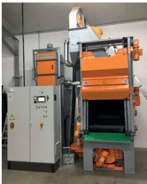
*Solution autonome avec filtre et armoire de commande*
