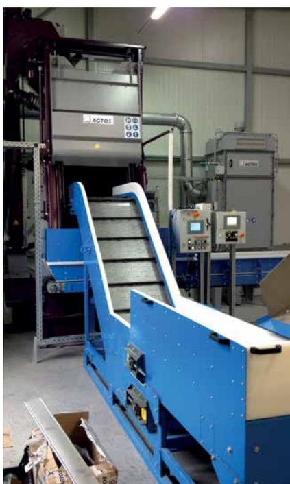
*Grenailleuse à tablier retourneur avec un dispositif de chargement spécial*
