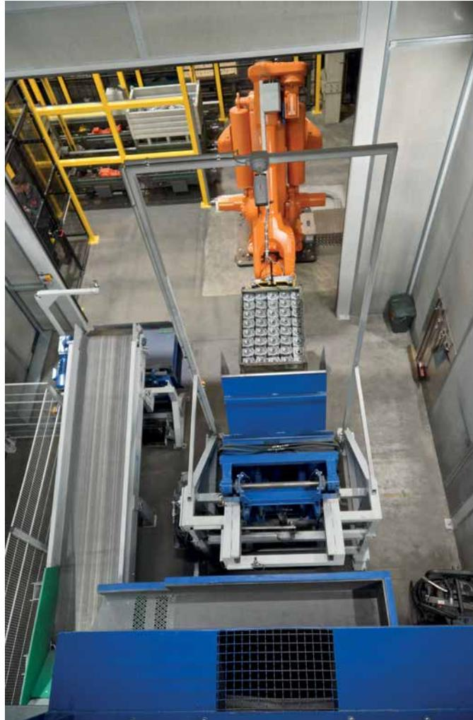
*Chargement du chargeur de la grenailleuse à tablier retourneur d'AGTOS par un robot*
