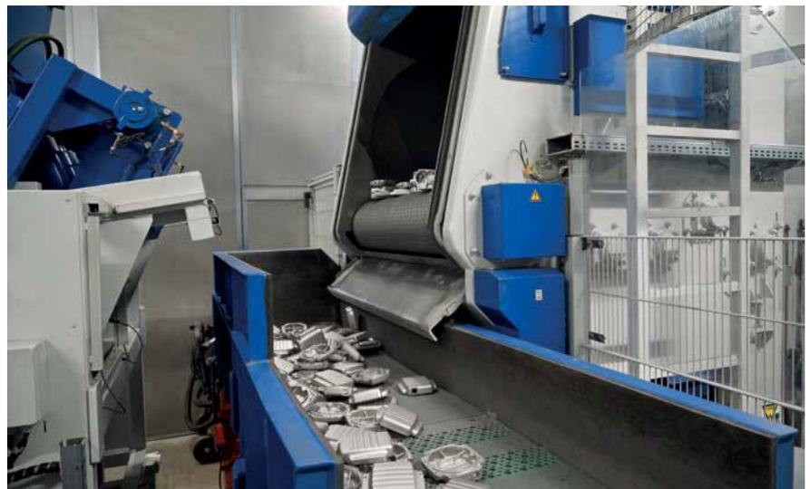
*Déchargement de la grenailleuse et retour des pièces dans la caisse fournie*
