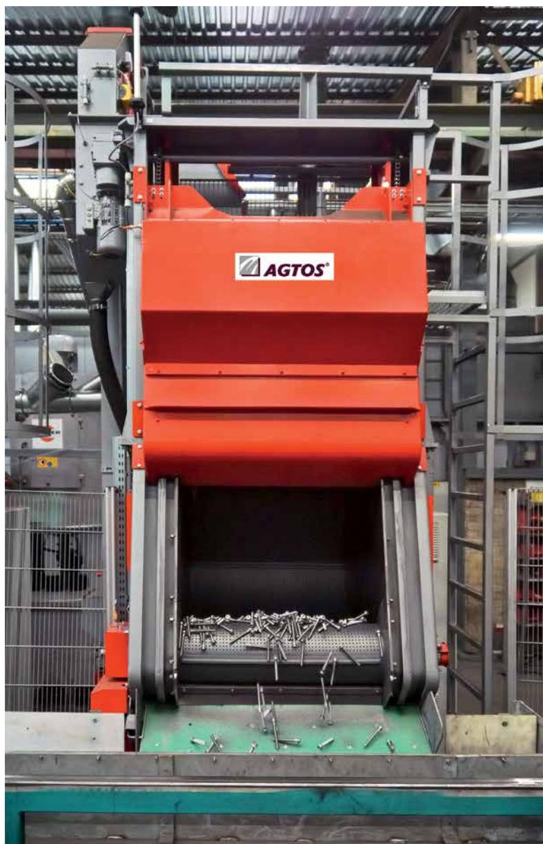
*Évacuation des pièces sur un tapis convoyeur et transmission à la prochaine étape du processus*
