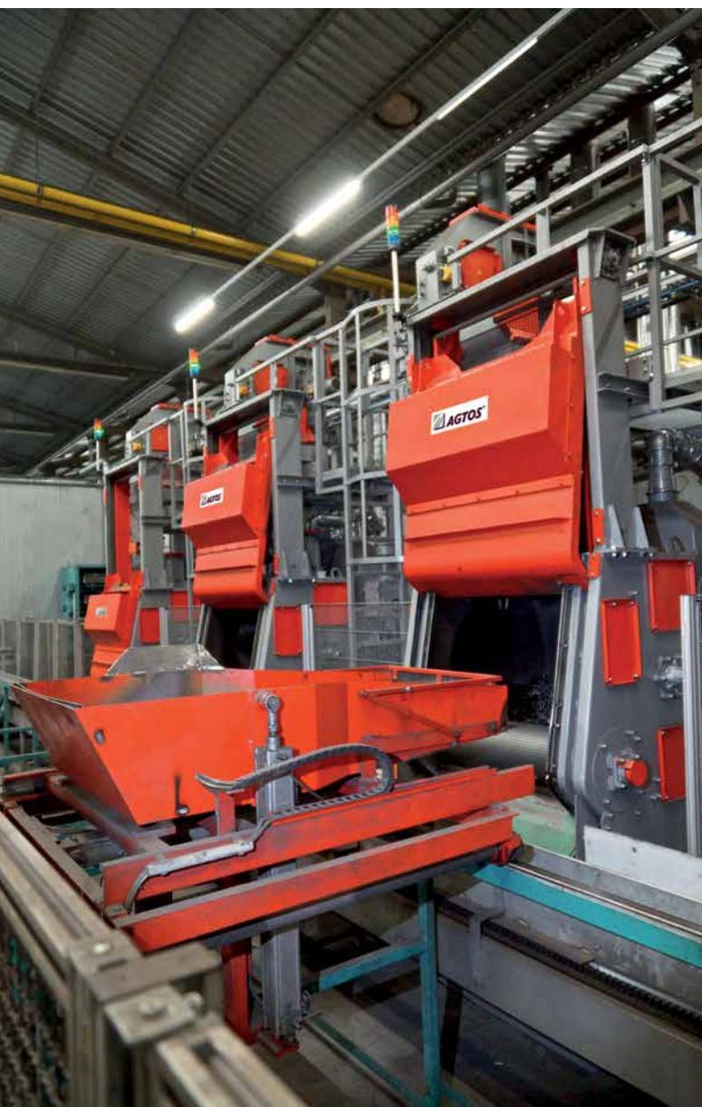
*Chargement doux des grenailleuses à l'aide d'un dispositif de chargement*
