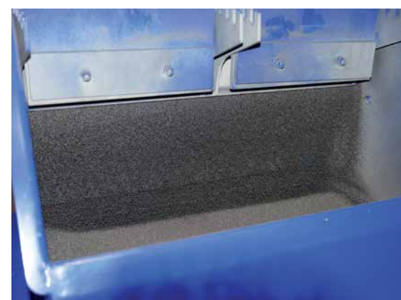
La poussière et l'abrasif trop fine sont séparés du mélange d'abrasif par l'aéroséparateur.
