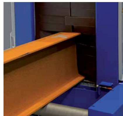
Étanchéité parfaite à l'entrée de la machine
