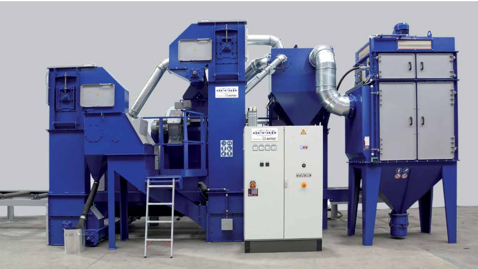
La vue de côté montre la construction compacte de l'«Ocean Blaster».
