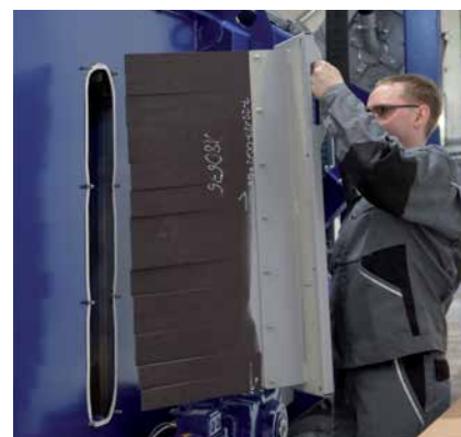
Echange facile des lamelles en caoutchouc
