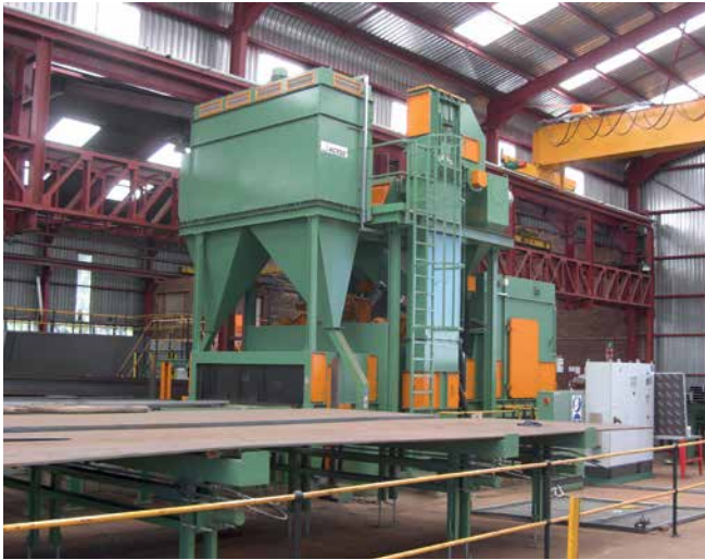
La grenailleuse à convoyeurs à rouleaux RT 26 d' AGTOS pour nettoyer et décalaminer des tôles et des profilés.
