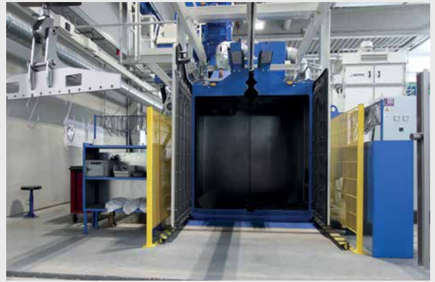
Dans la grenailleuse à charges suspendues HT 17-17 d'AGTOS, les petites pièces peuvent être grenillées automatiquement.
