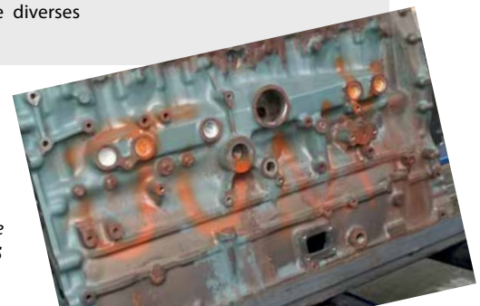
Bloc de moteur avant et après grenailage avec une OCEAN BLASTER d'AGTOS
