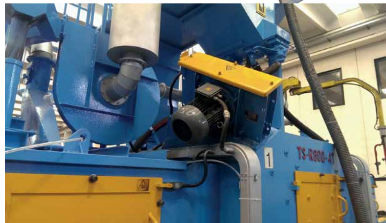
Grâce à l'installation de la turbine haute-performance d' AGTOS sur cette grenailleuse à tapis métallique, la vitesse du tapis a pu être considérablement augmentée. La durabilité des pièces d'usure est elle aussi bien meilleure.
