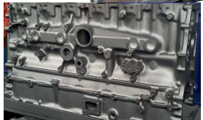
Bloc de moteur avant et après grenailage avec une OCEAN BLASTER d'AGTOS
